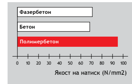
Якост на натиск на различни материали за отводнителни улеи
