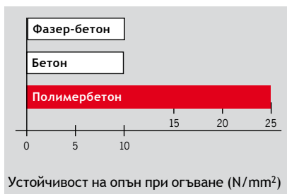
Устойчивост на опън при огъване на различни материали за отводнителни улеи
