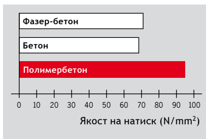
Якост на натиск на различни материали за отводнителни улеи
