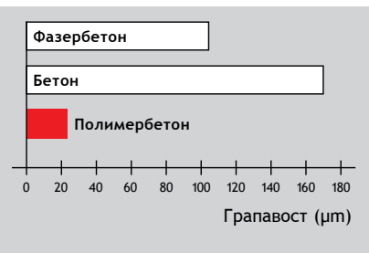
Средна грапавост на отводнителни улеи от различни материали
