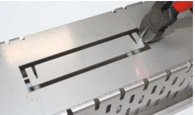
Фиксиращ елемент, интегриран в тялото на улея.
